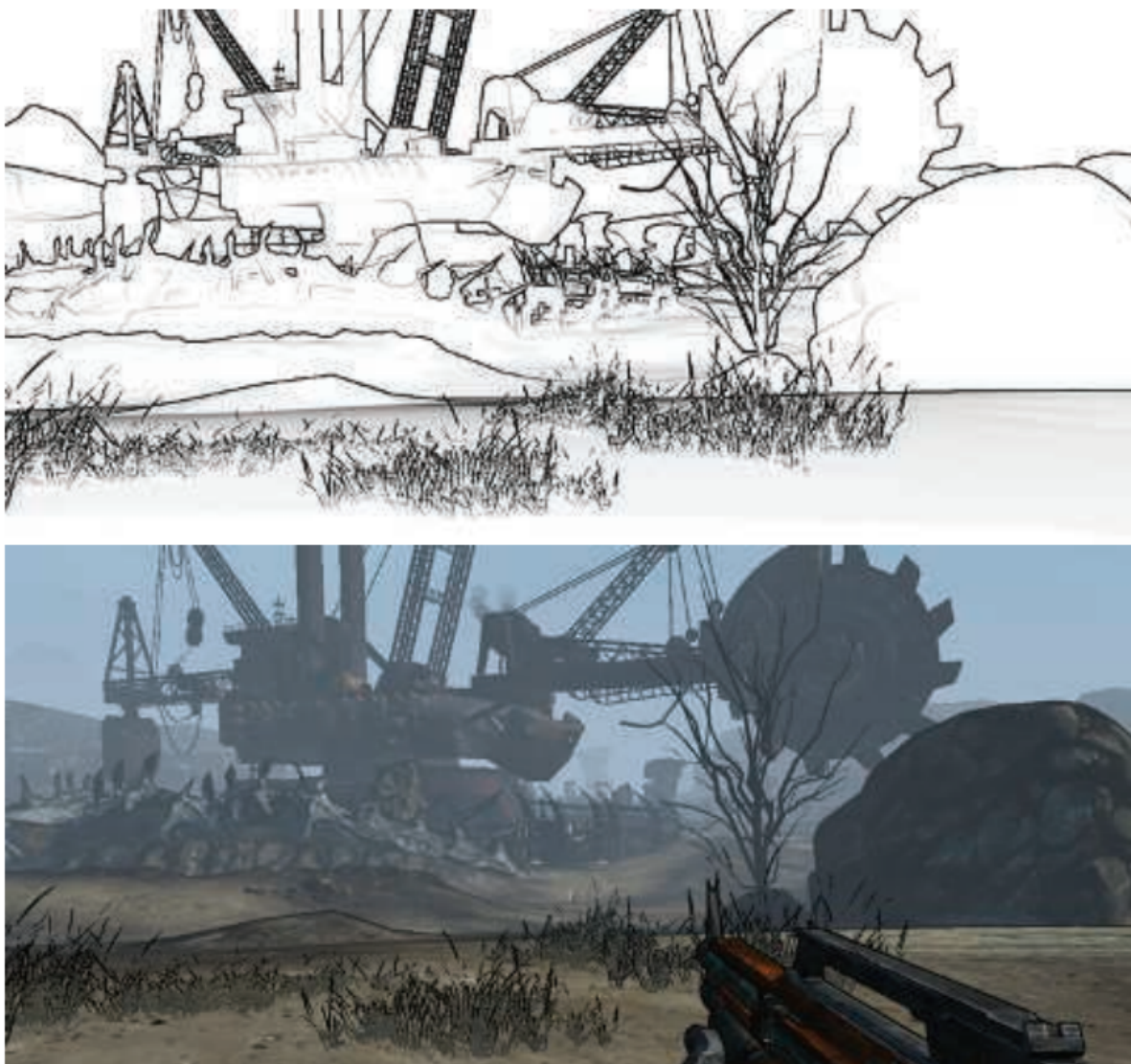
图 15.13: 对 Sobel 边缘检测进行了修改, 并应用在了游戏《无主之地》中。最终发布的版本 (并没有显示在这里) 通过掩盖前景中草的边缘, 来进一步改善外观表现。[1761]
