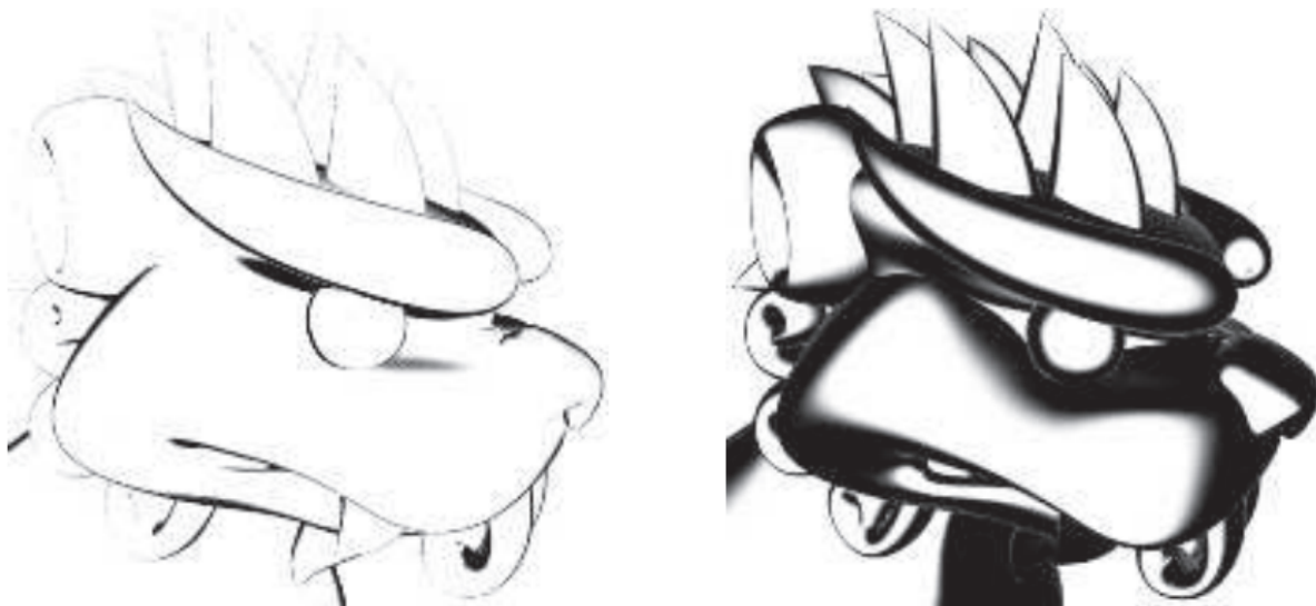
图 15.6：当着色法线几乎垂直于观察方向时，可以使得该处的表面变暗，从而对 contour 边缘进行着色。通过增大衰减的角度，可以显示一个更厚的边缘。
