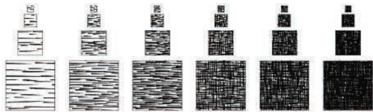
图 15.21：色调艺术贴图（TAM）。这些笔触被绘制到不同的 mipmap 层级中。每个 mipmap 层级中都包含其左侧和上方所有纹理中的笔触。通过这种方式，在 mipmap 层级和相邻纹理之间可以进行平滑的插值。
